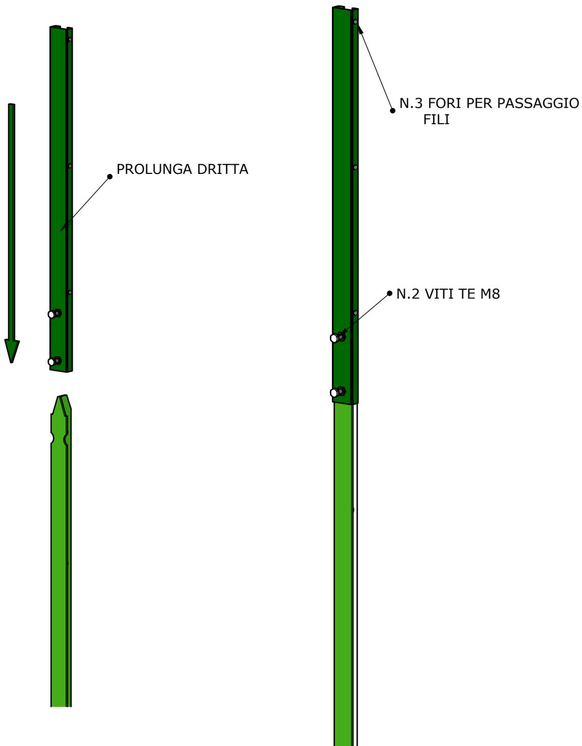
Infilare la prolunga dritta nel palo T per circa 130 mm e avvitare le viti TE M8 a battuta contro il palo per il bloccaggio. Dopo aver fissato le prolunghe dritte far passare i 3 fili di tensionamento per poi fissare la rete.
