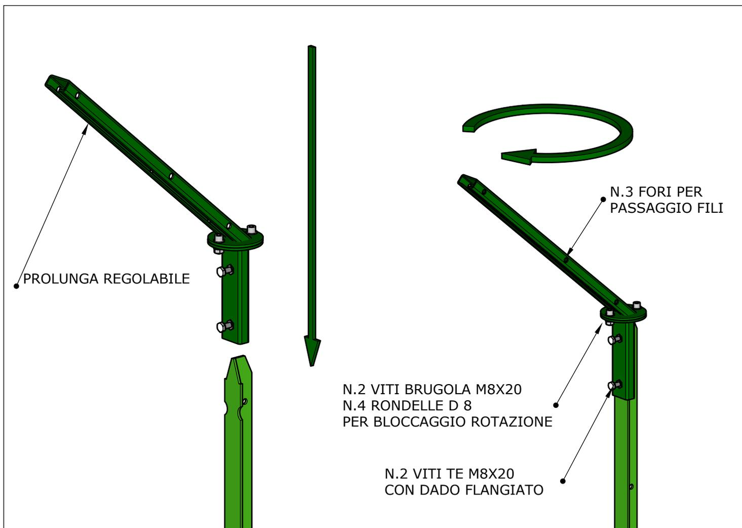
Infilare la prolunga regolabile nel palo a 'T', che è stato installato nell'angolo della recinzione, per circa 145 mm e avvitare le viti TE M8x20 a battuta contro il palo per il bloccaggio.
