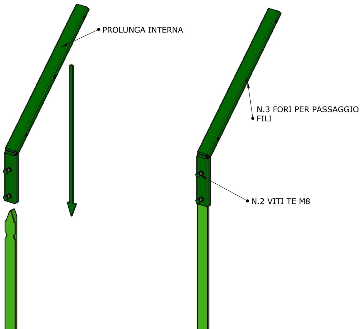
Infilare la prolunga interna nel palo a 'T' per circa 150 mm e avvitare le viti TE M8 a battuta contro il palo per il bloccaggio. Dopo aver fissato le prolunghe interne far passare i fili di tensionamento per poi fissare la rete.
