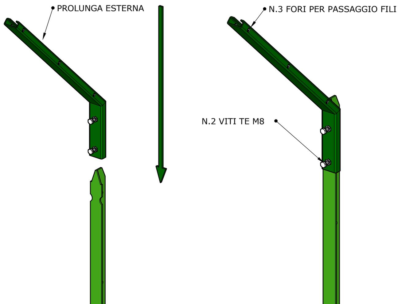
Infilare la prolunga esterna nel palo a 'T' per circa 150 mm e avvitare le viti TE M8 a battuta contro il palo per il bloccaggio. Dopo aver fissato le prolunghe esterne far passare i 3 fili di tensionamento per poi fissare la rete.
