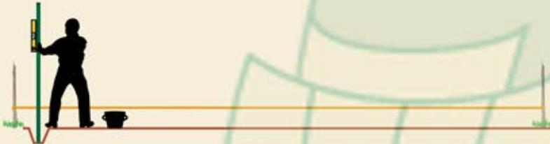
Realizzare nel terreno il foro per la posa del primo palo. Dotarsi di apposita livella per posare il palo perfettamente perpendicolare al terreno. Fissare con cemento.
