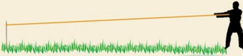
Preparare il terreno dove si poserà la recinzione in pannelli. Posare il picchetto e stendere il filo guida per poi installare i pali perfettamente allineati.
